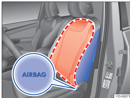
图 31 前排座椅侧面：侧面安全气囊的安装位置和膨胀范围
